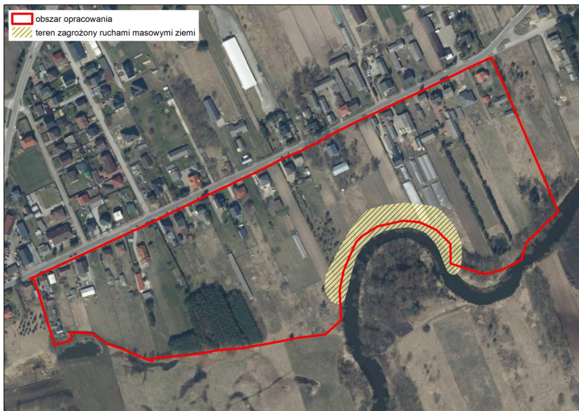
Rysunek 9. Zagrożenie osuwiskowe w granicach obszaru opracowania (źródło: opracowanie własne na podstawie danych SOPO, PIG-PIB)
