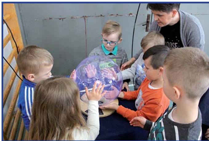
Szklana kula zawiera niewielką ilość mieszanki gazów szlachetnych: helu i argonu. Ręka przyłożona do kuli przyciąga nitki wyładowania.
